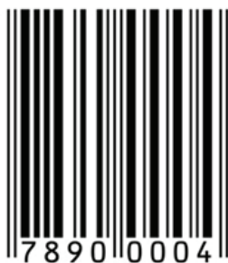
Figura 11: Representação de um código EAN 8:
