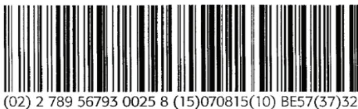
Figura 14: Representação de um código EAN 128
