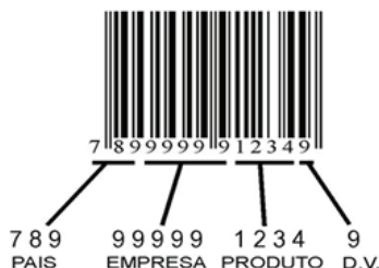
Figura 10: Representação de um código EAN 13:
